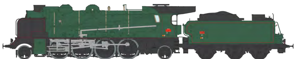
4-141 F 282 SNCF Montluçon railways depot - double smoke stack, small smoke deflectors, ACFI water pump, 25 m 3 25 A 44 tender, preserved in « La Cité du Train » Mulhouse museum. SNCF 4-141 F 282 Montluçon - Doppelschornstein, kleinen Windleitblechen, ACFI Pumpe, 25 m 3 25 A 44 Tender. Diese Lokomotive ist im Mulhouse Cité du Train Museum ausgestellt.
