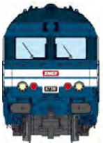
Diesel locomotive BB 67381 Caen railways depot Louvers and additional red headlighth Ep. IV BB 67381 Diesellok, Caen BW, mit Luftschlitzen und separaten roten Ampel, Ep. IV
