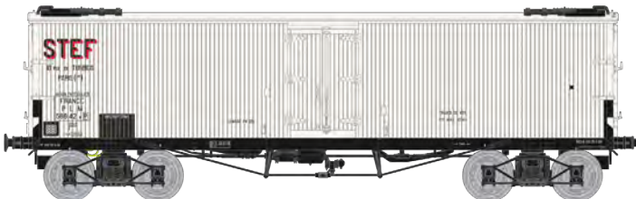
WB-579 - Origine à trappes à glace PLM STEF Ep.II (avec essieux Griffin) Original condition with Ice filling Trapdoors PLM STEF Ep.II (with Griffon axles) Ursprungsausführung mit Eisluken PLM STEF Ep.II (mit Griffin Achsen)
