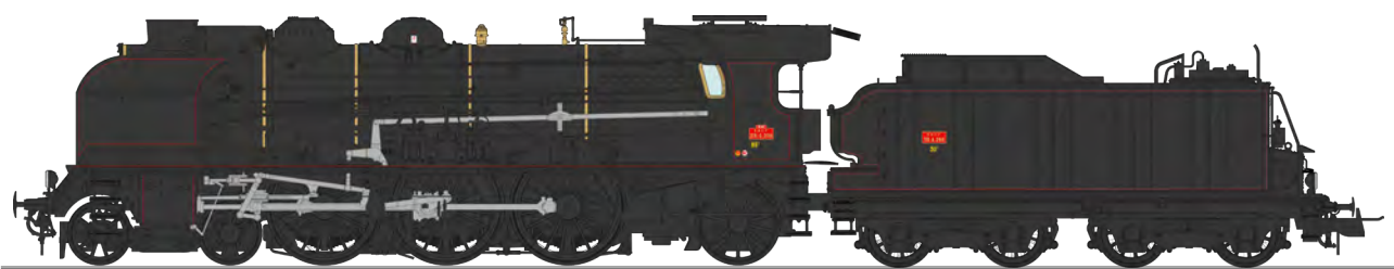
1-231 G 236 SNCF Reims - Cheminée double, grands écrans pare-fumée, pompe Bi-Compound, ACFI, tender 30m 3 , Noire SNCF, filets rouges - Ep.III MB-135 Analogique - MB-135S : DCC Sound échappement fumée - MB-135SAC : AC analogique échap. fumée
