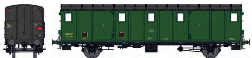
Black riveted roof and ends, 2 small headlights, pillow block bearings, «Sotteville» Ex- ETAT metal bars on windows N°39824 Ep.III Dach genietet und Stirnwand schwarz, 2 kleine Schlusslichter 1 rechts, Gleitachslager, «Sotteville» Ehem. ETAT, Fenstergitter, N°39824 Ep.III
