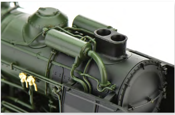
4-141 F 282 SNCF Montluçon railways depot - double smoke stack, small smoke deflectors, ACFI water pump, 25 m 3 25 A 44 tender, preserved in « La Cité du Train » Mulhouse museum. SNCF 4-141 F 282 Montluçon - Doppelschornstein, kleinen Windleitblechen, ACFI Pumpe, 25 m 3 25 A 44 Tender. Diese Lokomotive ist im Mulhouse Cité du Train Museum ausgestellt.
