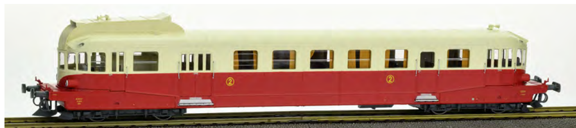
VH railcar X-2119 ex-PLM AVIGNON, Red/Cream, top corner headlights and cowcatcher snowplow Ex-PLM X-2119 VH Dieseltriebwagen AVIGNON, Rot-Cremweiß, Ecklichten und Schienenräumer
