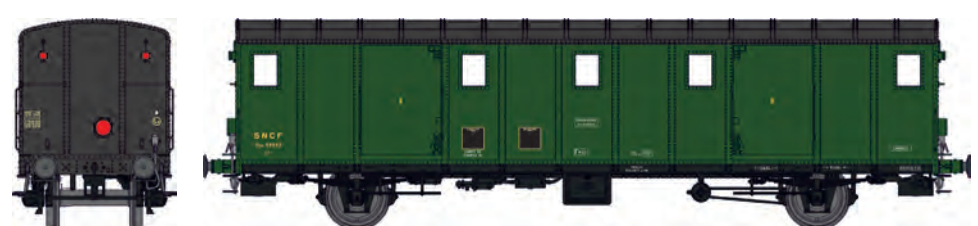
Black riveted roof and ends, 2 small headlights and 1 centered, pillow block bearings, «Limoges» Ex-PO Fenced windows N°49842 Era III Dach genietet und Stirnwand schwarz, 2 kleine Schlusslichter und 1 mittig, Gleitachslager, «Limoges» Ehem. PO, Fenstergitter, N°49842 Ep.III
