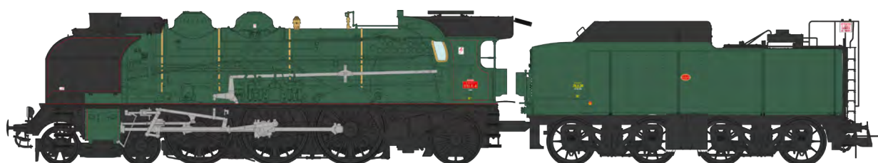
2-231 K 4 Boulogne - Cheminée double, grands écrans pare-fumée, pompe Bi-Compound, ACFI, tender 38m 3 , machine et tender Vert, filets rouges - Ep.III
